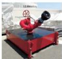
③ 大型放水砲
